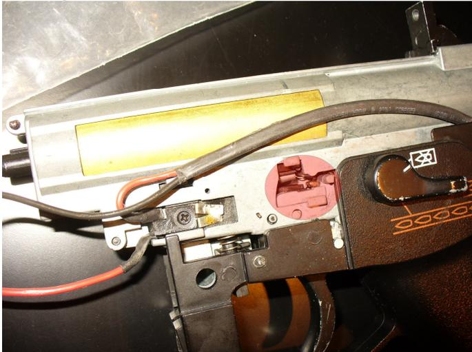
Der „**Cut-Off-Lever (COL)**“ ist für die Kontrolle des semi-automatischen **Feuermodus** zuständig. Er bedient die Stromabschaltung und ist auch von außen zu betätigen. Der „Gearbox“ muss hierzu freigelegt, aber nicht geöffnet werden.
