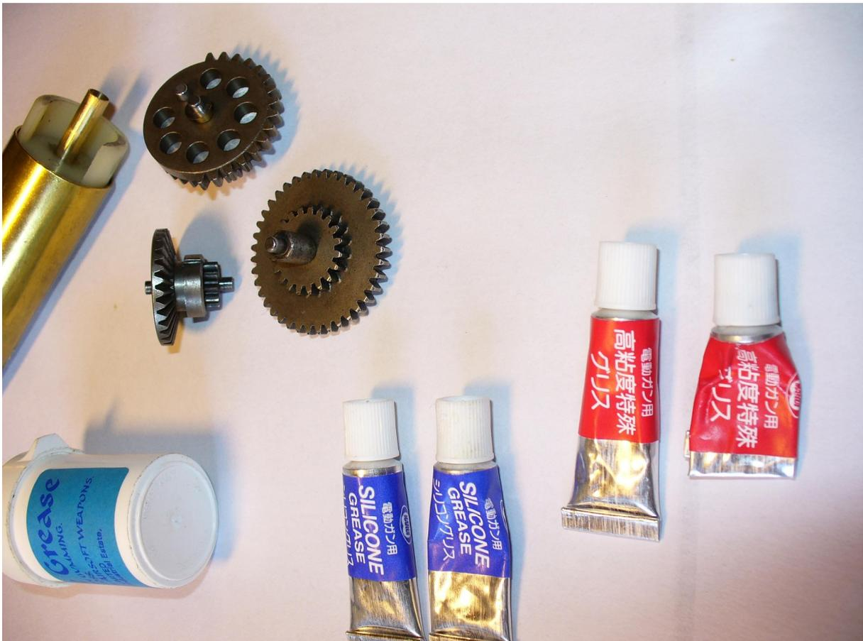
Da innerhalb einer „Gearbox“ starke Kräfte wirken und **Verschleißerscheinungen** auftreten, ist es früher oder später notwendig die „Gearbox“ zu warten. Prinzipiell gilt: „Umso stärker die Feder innerhalb der „Gearbox“, desto größer der Verschleiß!“
