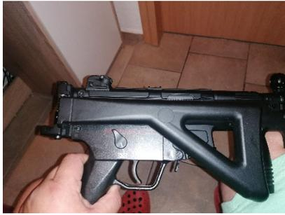
Als erstes fällt uns die eingeklappte Schulterstütze auf, die man durch eine leichte Klappbewegung nach links öffnen kann und nach hinten klappen kann. Dort rastet sie natürlich ein. Dieses ist durch den Stift mit der Feder gesichert. Um sie wieder zurück zu klappen, muss man sie gegen die Federspannung leicht anheben und dann zurückklappen.
